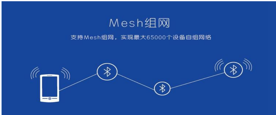
图9. Mesh 组网示意图
